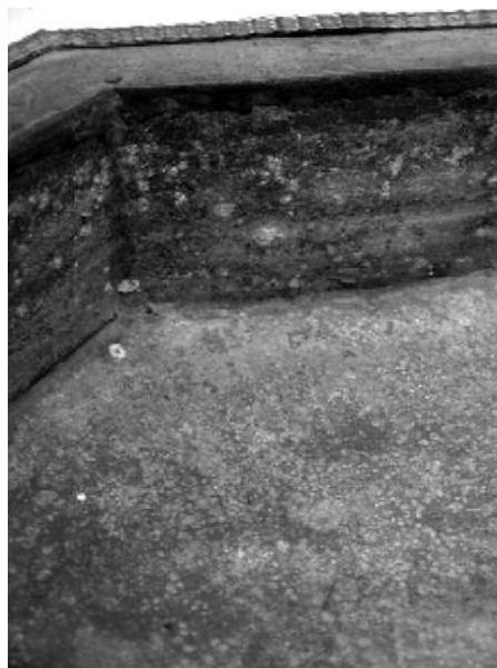
Ryc. 8. Misa chrzcielna z Chojnic. Procesy korozyjne dna i ścianek zbiornika misy (fot. M. Kołyszko)
